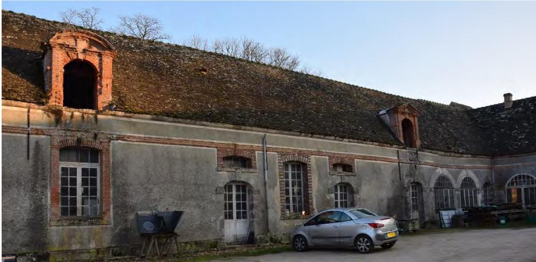
Les communs ont une architecture très harmonieuse avec des encadrements de baies en brique et des lucarnes à frontons triangulaires et circulaires. La toiture à longs pans en tuiles plates est à deux versants. A proximité de l'orangerie, une porte cochère permet de franchir les douves.
